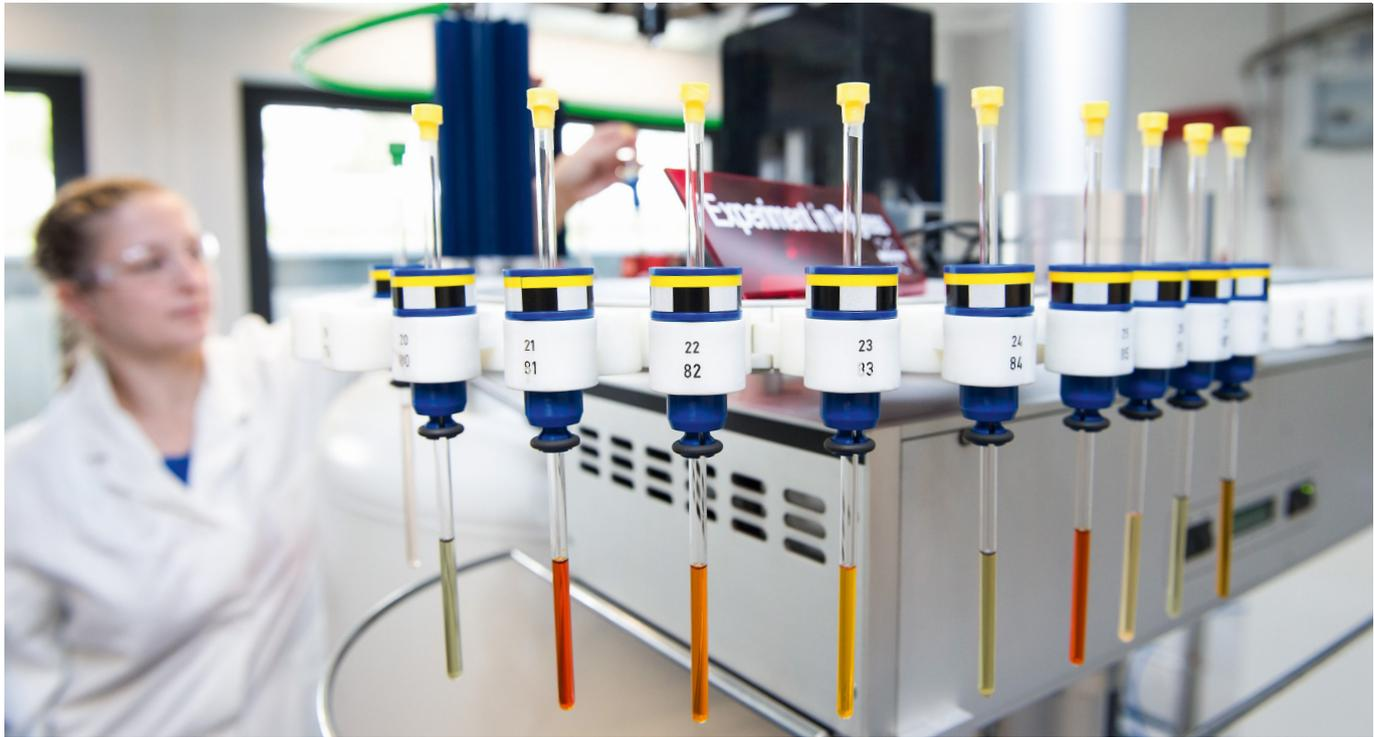
*In einem nicht zielgerichteten Verfahren werden durch die Kombination von Spektroskopie und multivariater Datenanalyse die spektroskopischen Charakteristika der Inhaltsstoffe einer Probe – also ihr physiko-chemischer Fingerabdruck – beschrieben.*
