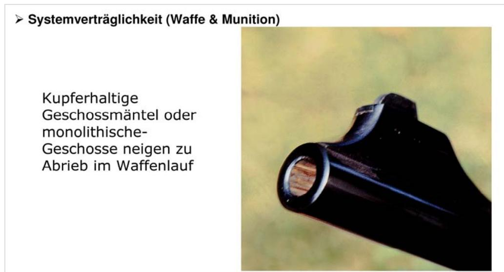
Abb. 1: Ablagerung im Lauf nach dem Abschuss eines nichtbleihaltigen Geschosses. Die Gefahr des Barrel Fouling steigt.
