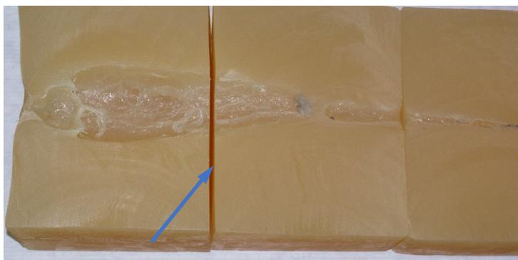
Abb. 15: Der sichtbare Spalt (blauer Pfeil) kann durch Unterlegen von schmalen Streifen aus Pappe auf der linken Seite (Einschussbereich) beseitigt werden.
