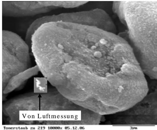
**Abbildung 33:** REM-Aufnahme einer Streuprobe von Tonerstaub im Vergleich mit einem Partikel (Pfeil) auf der Filterprobe 219 (Raum B-20) der entsprechenden Luftmessung während des Druckvorgangs (beide Aufnahmen bei 10.000-facher Vergrößerung)
