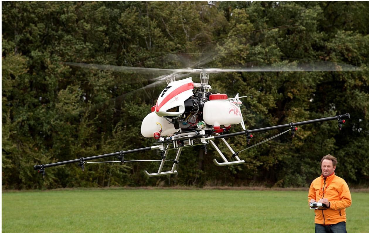
Antrieb: 2-Takt-Boxermotor 14.5 kW (20 PS); Flettner-Rotorsystem: 2,9 m über beide; Flugzeit: etwa 30'
