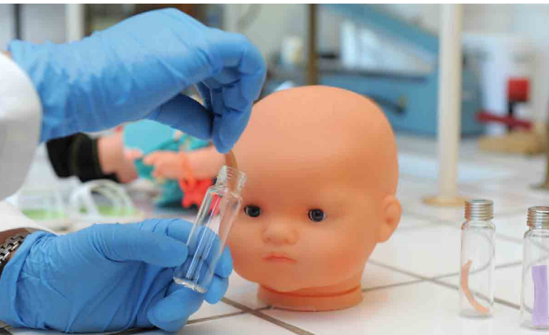
Probenvorbereitung für die Bestimmung der Emission von allergenen Duftstoffen aus bedufteten Spielwaren.
