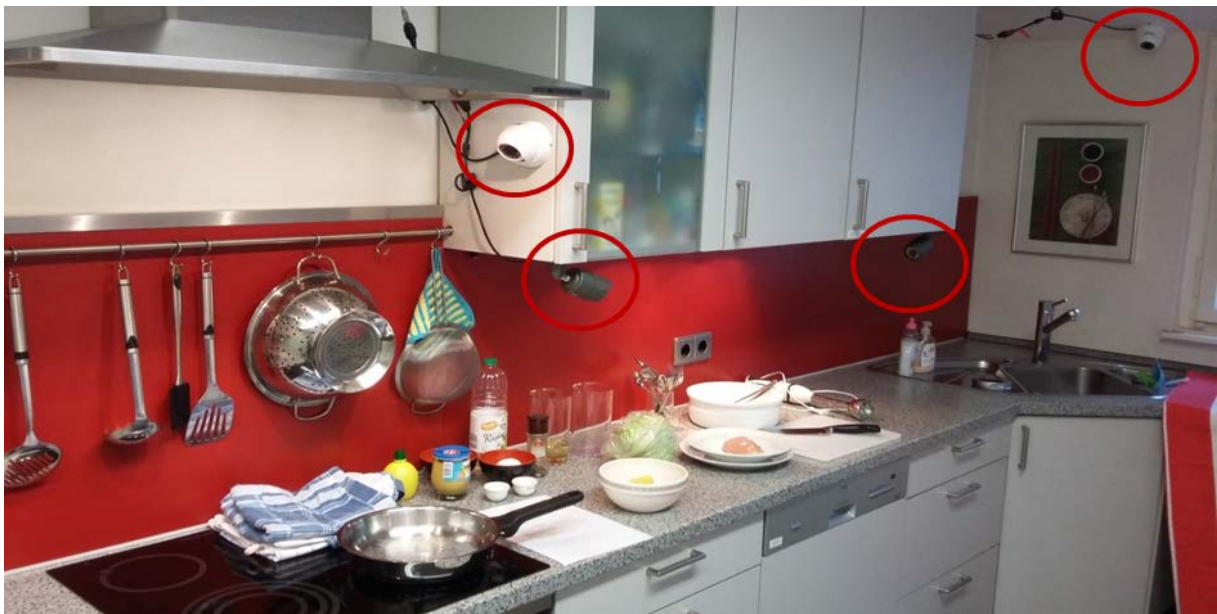
Abb. 12: Versuchsaufbau in der Versuchsküche und Kamerapositionen (rot markiert)
