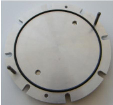
1. Messzelle mit Dichtring
