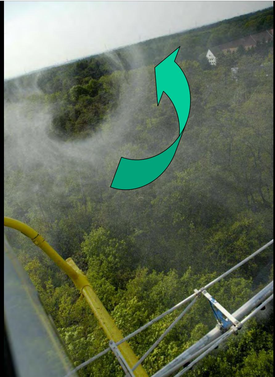
**Eigenrotation (Turbine) stabilisiert Spritzbahn !**
