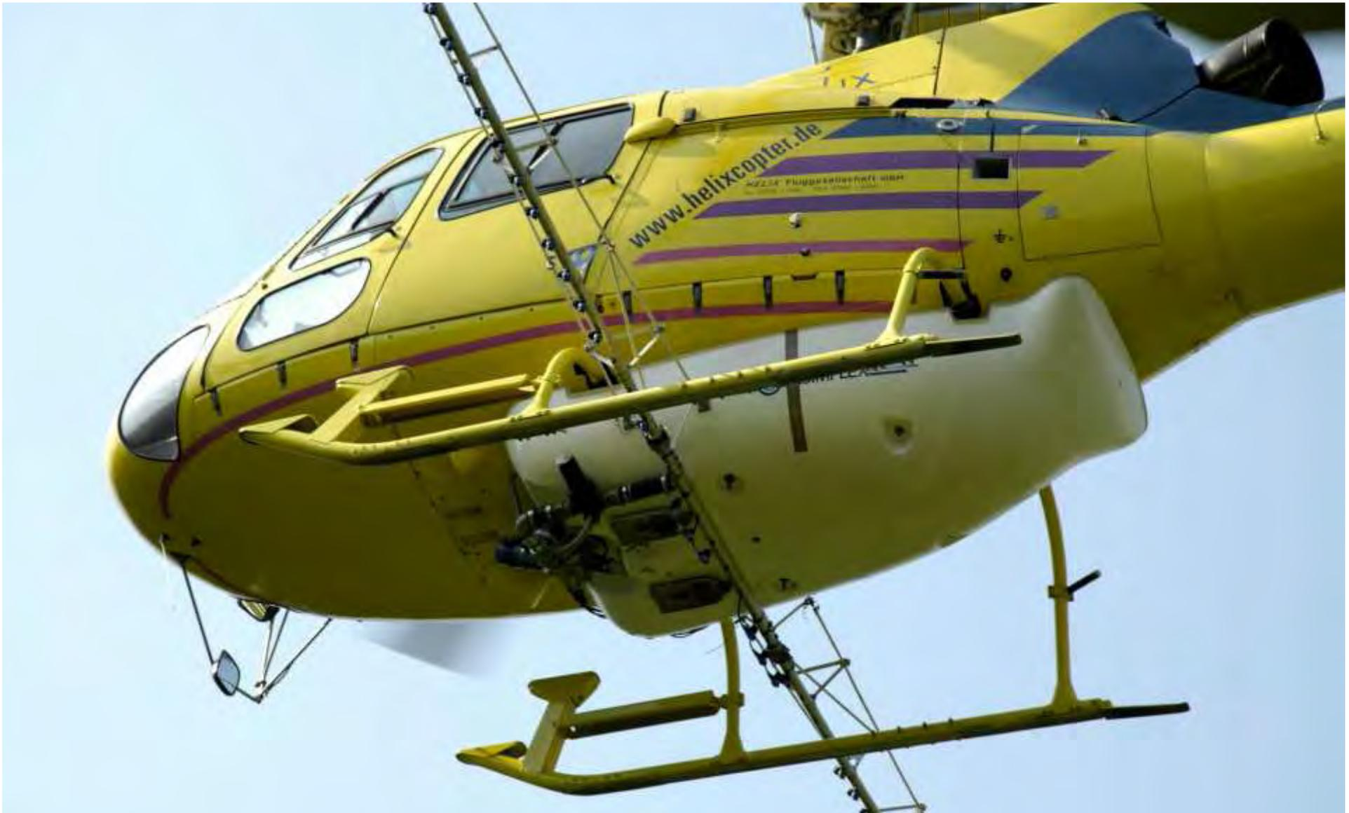
**Heutiger Standard:** Leistungsstarke Maschine (AS350), Simplex-Sprühanlage, Injektordüsen (TeeJet 120/05), GPS-Steuerung
