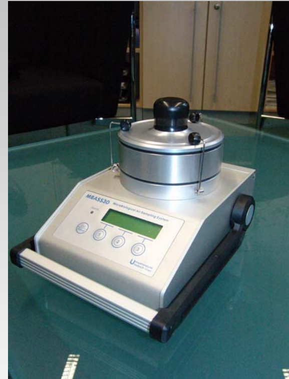
Holbach MBASS30 Mit LKS30-Keimzählkopf Volumenstrom: 30 L/min Sammelzeit: ~7 min Sammelvolumen: 0,2 m 3 Nährmedien: MEA / DG18 auf Standardpetrischale
