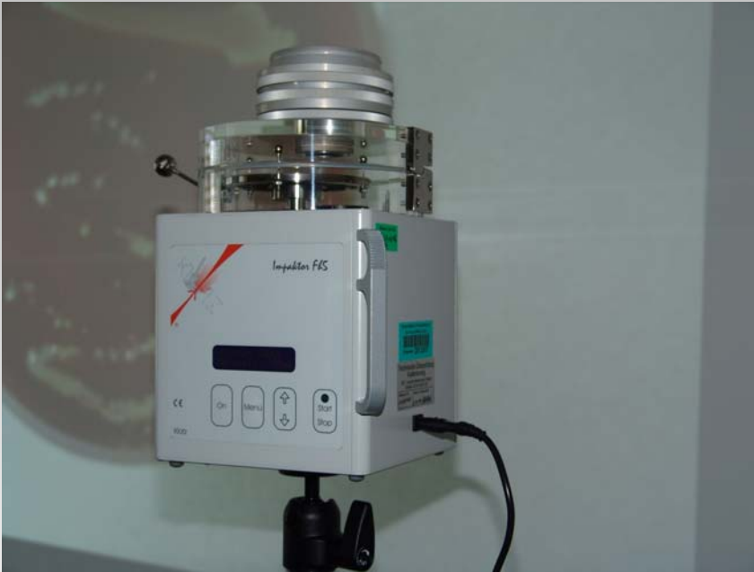
Leschke Impactor FH5 Volumenstrom: 100 L/min Sammelzeit: 10 min Sammelvolumen: 1 m 3 Nährmedien: MEA / DG18 auf Standardpetrischale
