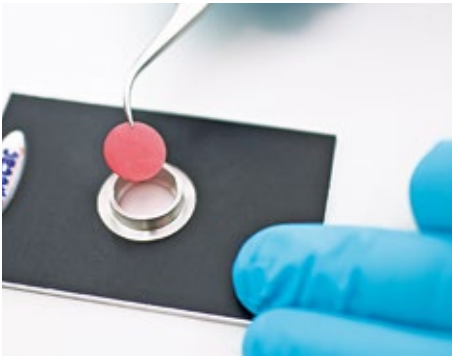
Für die Analyse per Fourier-Transform-Infrarotspektrometrie wird von den prüfenden Farben zunächst ein Pressling hergestellt und dieser anschließend untersucht.
